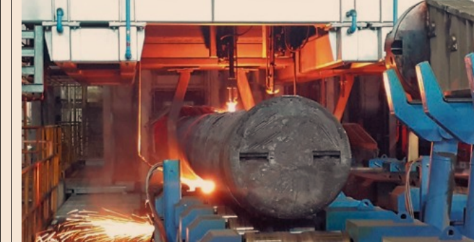
Primo impianto al Mondo per tagli blumi su colata continua da 1050mm
